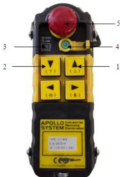
1. 左旋 2. 右旋 3. 动作及弱电指示灯 4. 电源开关 5. 急停按钮
