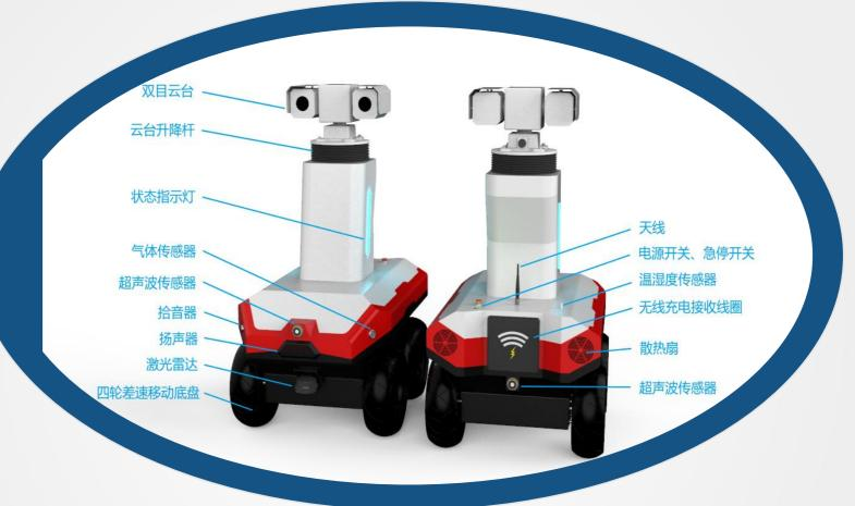
目前智能巡检机器人本体搭载环境监测传感器、360度双目云台(包括可见光摄像头、红外热成像仪)、双向语音系统、声光报警系统、智能化辅助单元等。
